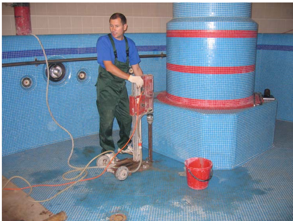
Фото 13. Бурение скважины С А-6 установкой «Hilti» для отбора керна алмазной коронкой с уровня дна бассейна.
