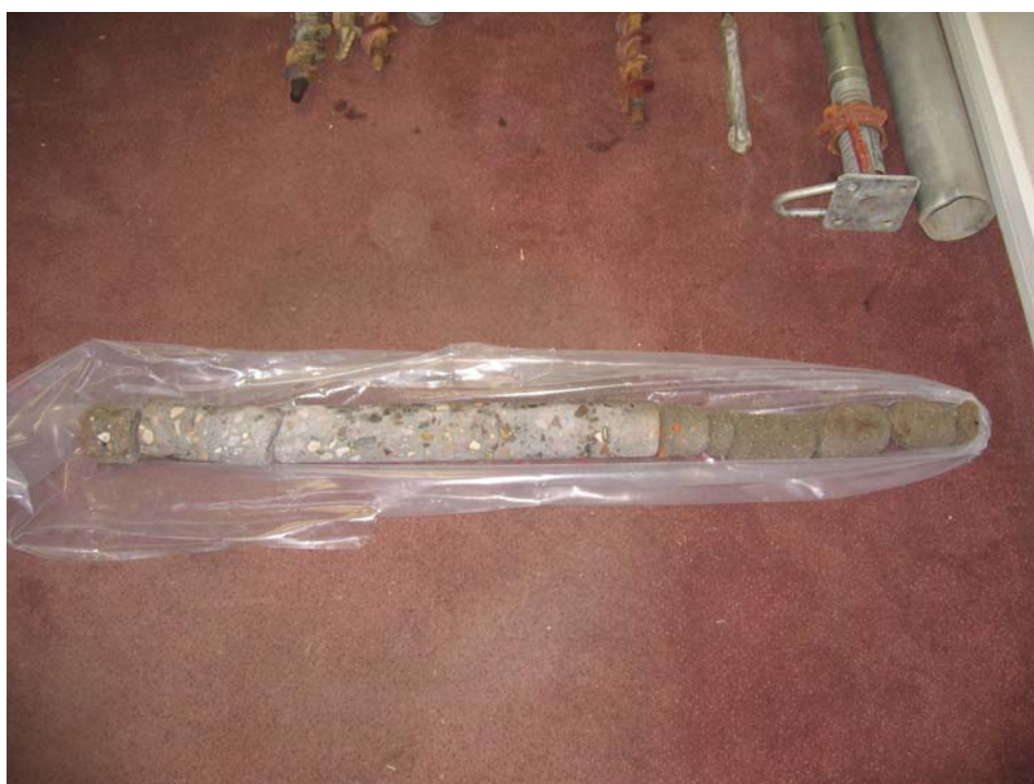
Фото 18. Вид керна из скважины-вскрытия СА-5.
