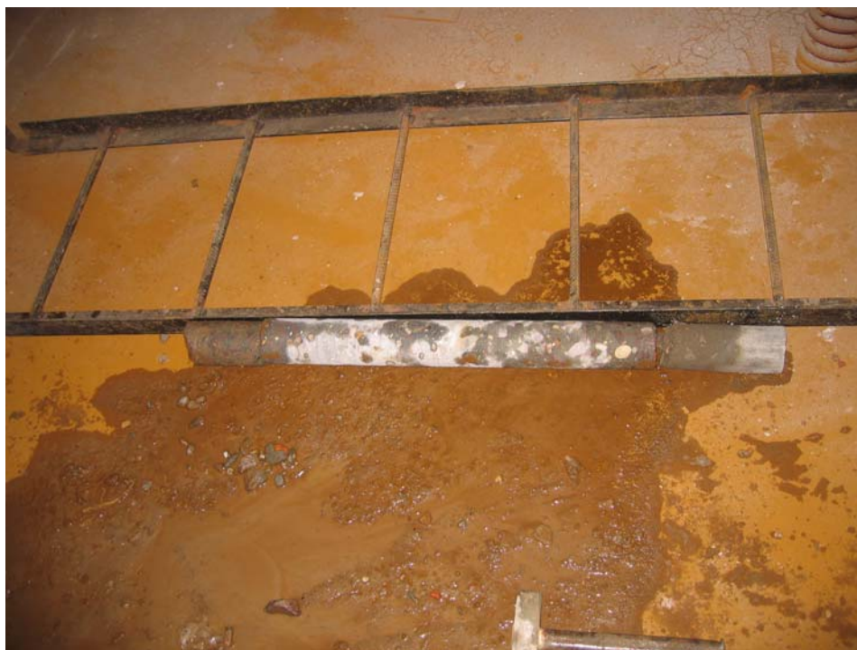
Фото 17. Общий вид керна цементно-песчаного раствора и бетона, извлеченного из скважины СА-4.
